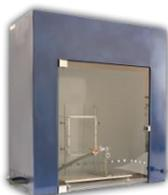
Прибор предназначен для проведения испытаний на воспламеняемость тканей в соответствии с ГОСТ Р 50810-95. Настоящий стандарт устанавливает метод определения способности текстильных материалов (тканей, нетканых полотен) сопротивляться воспламенению, устойчивому горению, а также оценки их огнезащитности. Стандарт применяется для всех горючих декоративных текстильных материалов. По результатам испытаний горючие текстильные материалы подразделяют на легковоспламеняемые и трудновоспламеняемые.
